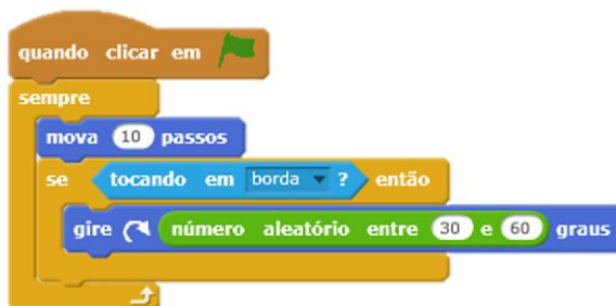
Figura 33 – Parâmetros blocos operadores
