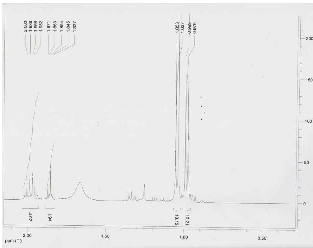
Figura 127 - Espectro de RMN ^1\text{H} (400 MHz, \text{CDCl}_3 ) (Expansão da região entre 05,0-2,0 ppm) da 6',7'-diidro-12, 12a-desidrorotenona
