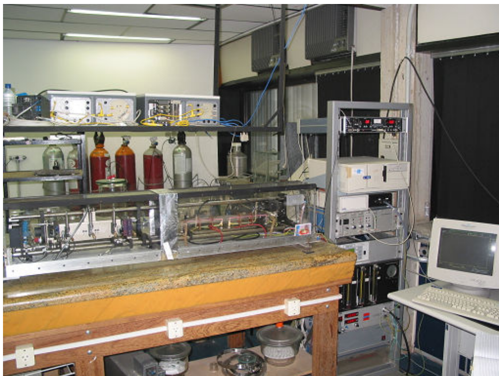
Figura 1 - Fotografia do espectrômetro fotoacústico utilizado para a detecção de etileno.
