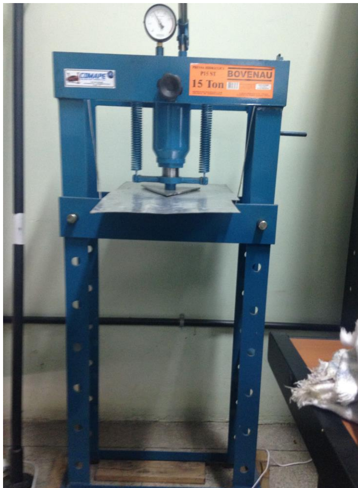
Figura 10: Prensa hidráulica utilizada para extração do óleo de chia.
