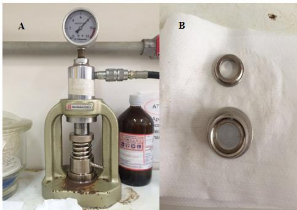
Figura 14: Etapas da confecção da pastilha de KBr. A) Aparado sendo prensado à 8 toneladas e B) Pastilha de KBr pronta para receber a gota de amostra.
