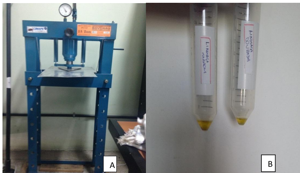
Figura 7: A) Prensa hidráulica utilizada para extração dos óleos de linhaça marrom e linhaça dourada. B) Óleos extraídos.
