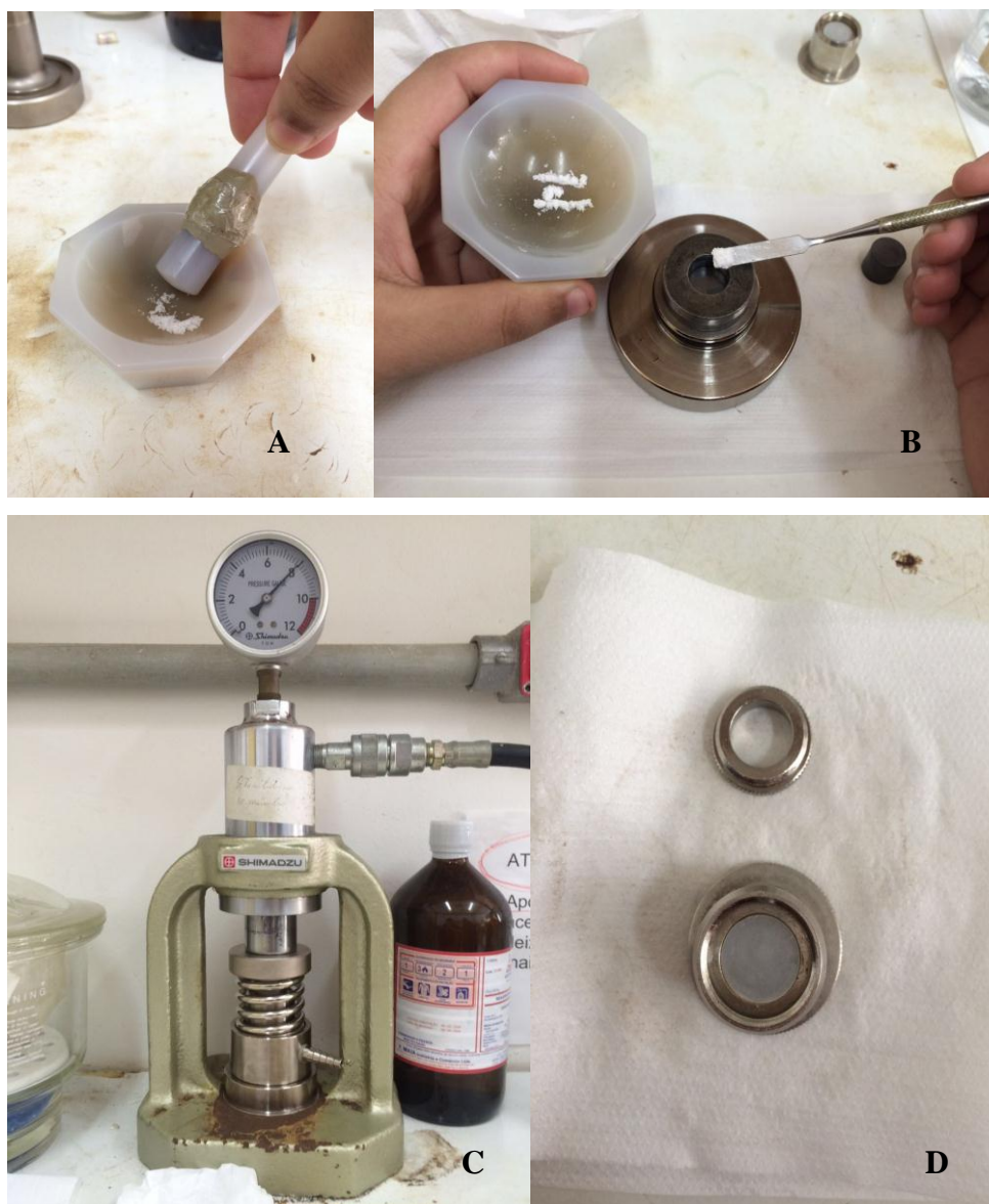
Figura 8: Etapas da confecção da pastilha de KBr. A) Maceração do KBr; B) KBr já macerado e colocação nas peças para prensagem. C) Aparado sendo prensado à 8 toneladas e D) Pastilha de KBr pronta para receber a gota de amostra.
