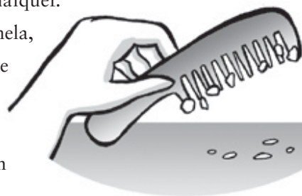
Figura 5.1: O pente, que sofreu atrito com a seda, atrai pedacinhos de papel.
