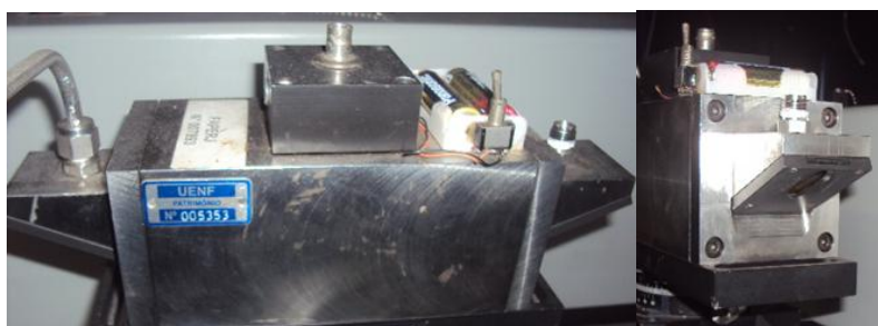
Figura 21 - Foto frontal e lateral da célula fotoacústica descrita da seção 2.3.6A.
