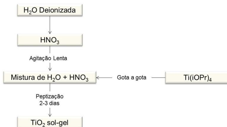
**Figura 9.** Fluxograma representativo do método de preparação do sol-gel  $\text{TiO}_2$ .
