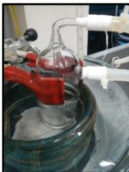
**Figura 14.** Foto do saturador contendo formaldeído líquido imerso em um banho de água na temperatura de 10 °C.
