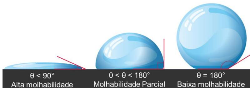
**Figura 22.** Esquema do comportamento de uma superfície (a) alta molhabilidade  $\theta \sim 0^\circ$ , (b) molhabilidade parcial  $0 < \theta < 180^\circ$ , e (c) de baixa molhabilidade  $\theta = 180^\circ$ .
