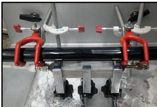
**Figura 17.** Foto mostrando a localização da fonte de radiação durante os testes fotocatalíticos
