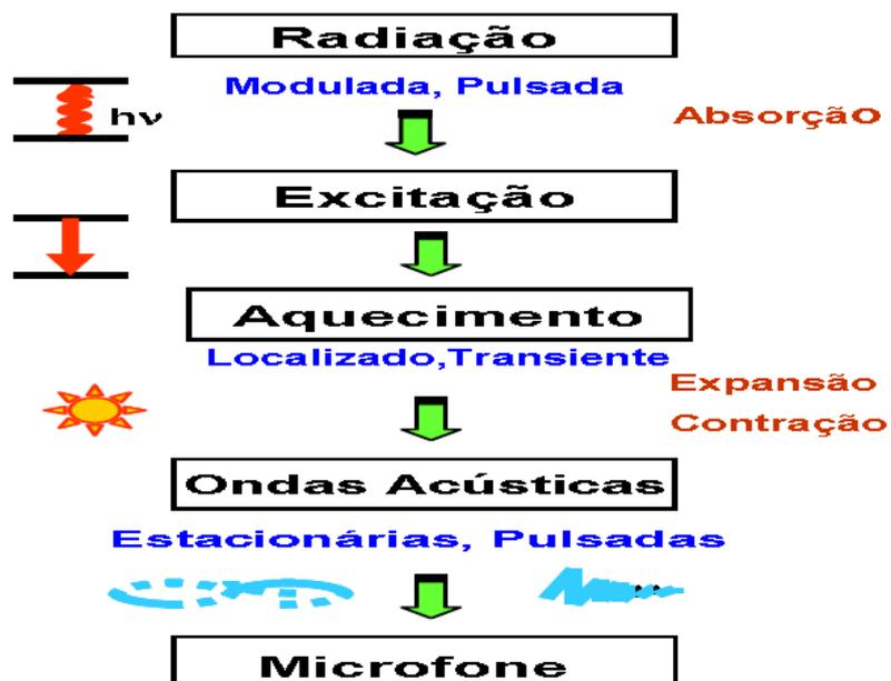
Figura 3.2.1.3: Desenho Esquemático das Etapas para Obtenção do Sinal Fotoacústico [F. M. Couto, 2011].
