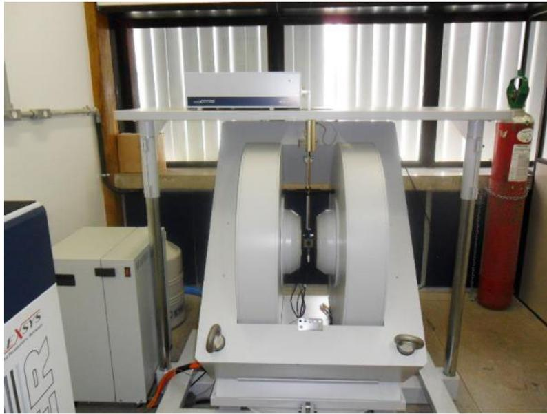
Figura 19 – Espectrômetro Bruker E500
