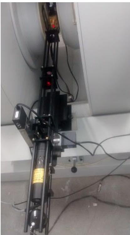
Figura 27 – Suporte projetado, com laser e lentes, fixado aos transladores  $xy$  sobre o espectrômetro RME
