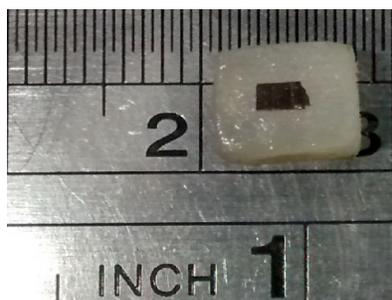
Figura 60 – Imagem da amostra de fita cassete com a orientação da direção de gravação paralela ao campo magnético aplicado
