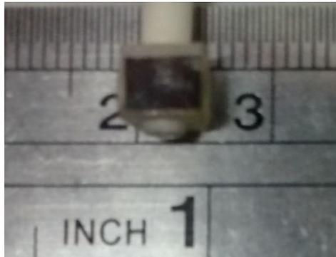
Figura 64 – Amostra de fita cassete utilizada no experimento para aquisição de imagem de defeito estrutural
