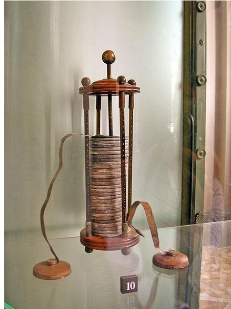
Figura 4: Pilha de Volta, discos de Cu e Zn empilhados e embebidos em uma solução ácida.
