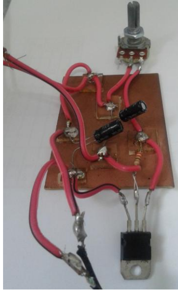
Figura 16: Regulador de tensão feito por aluno após receber as orientações do apêndice IX.
