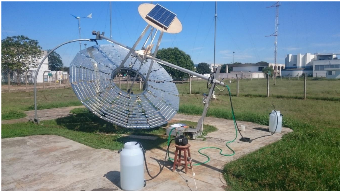
Figura 32 - Configuração de experimento microbiológico realizado no Disco Solar
