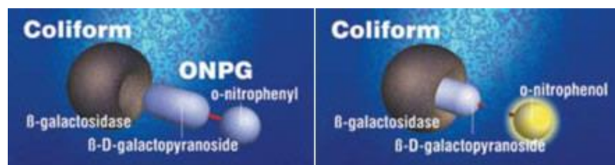
Figura 33 - Mecanismo de detecção de coliformes totais
