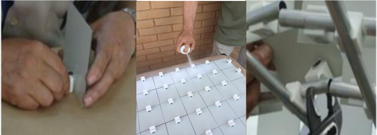
Figura 26 - Preparação e colocação dos espelhos primários no suporte
