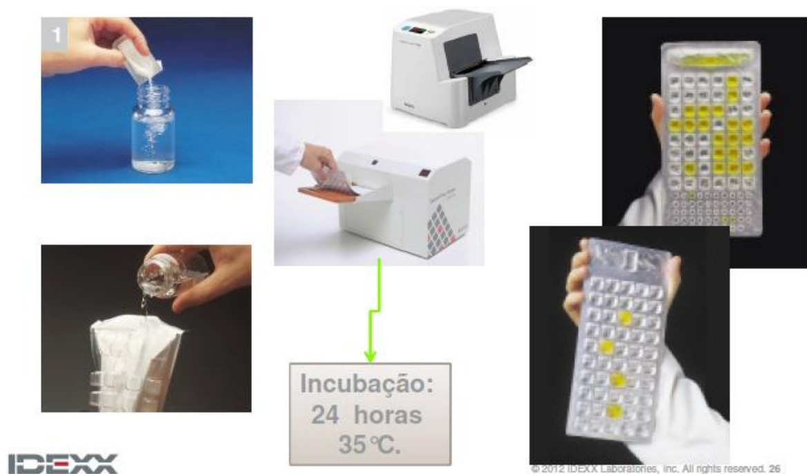
Figura 35 - Técnica de Quantificação de Coliformes Totais e coliformes Fecais por Colilert
