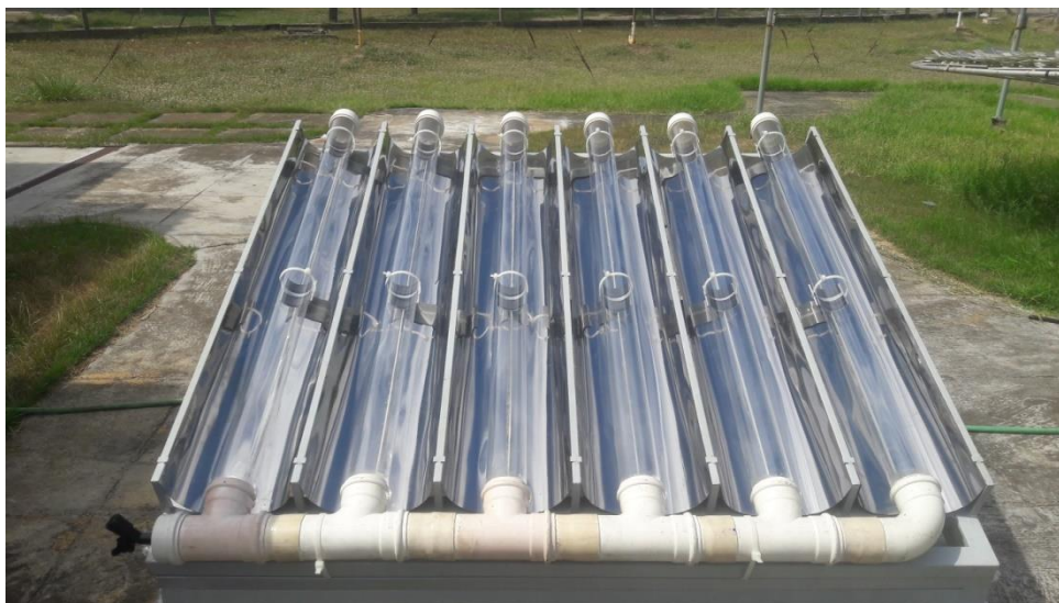
Figura 50 - Reator CPC construído no Brasil
