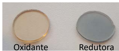
Figura 4.29: Amostras CAMB produzidas em condições oxidante e redutora.
