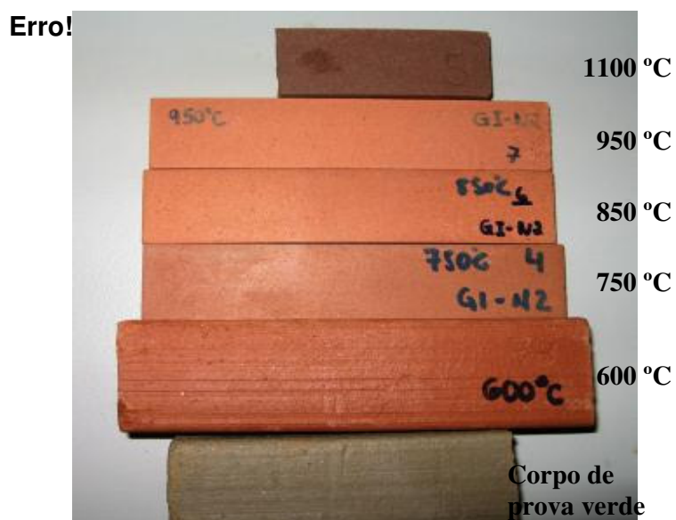
Figura 7: Corpos-de-prova queimados em diferentes temperaturas com variação na coloração.
