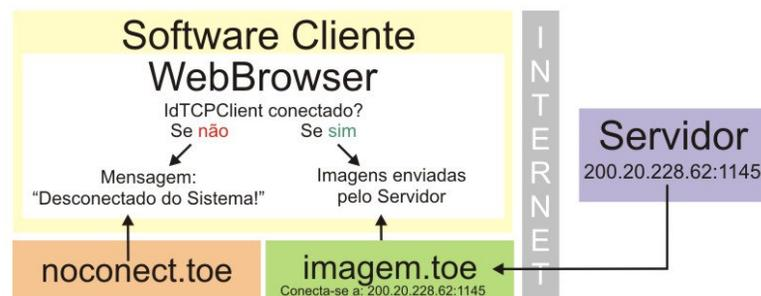
**Figura 11 – Esquema de funcionamento do componente WebBrowser e arquivos “imagem.toe” e “noconnect.toe”.**
