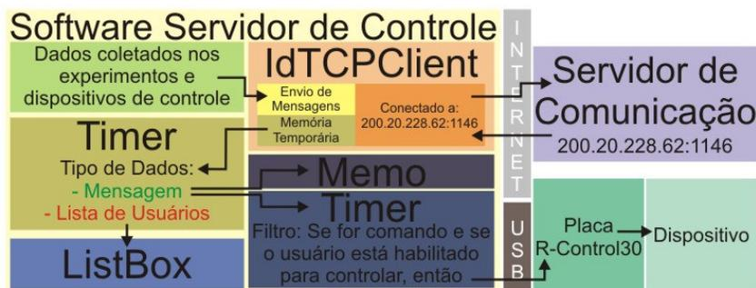
**Figura 13 – Esquema de funcionamento do componente IdTCPClient e filtro de verificação de comandos.**
