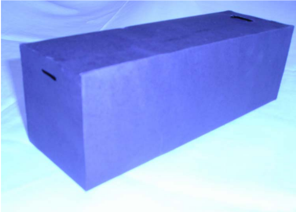
Figura 3.6: Visão exterior do espectrômetro. As fotografias dos espectros apresentadas neste trabalho foram tiradas acoplando uma máquina digital no orifício superior do espectrômetro.
