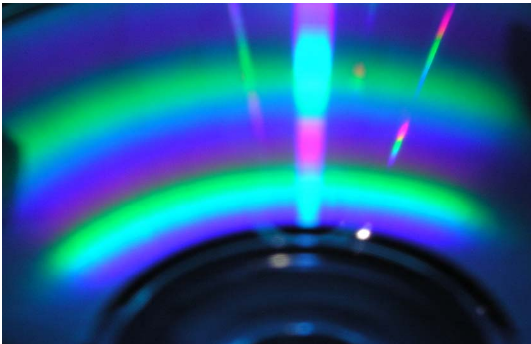
Figura 3.9: Imagem do espectro solar obtida com o espectrômetro coberto com celofane azul.
