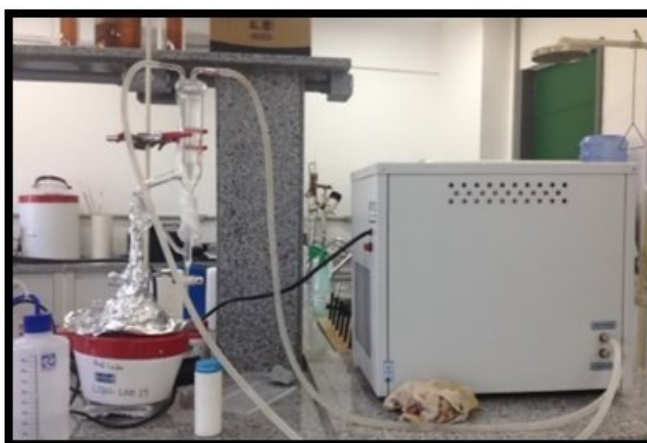
Figura 8. Extração com aparelho de Clevenger
