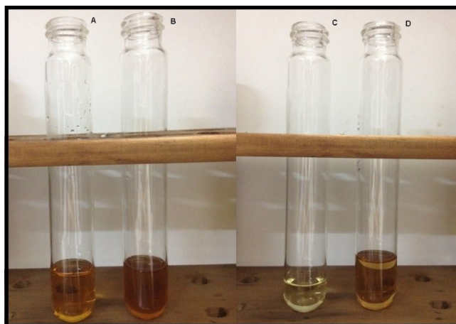
Figura 21. Reação com Hidróxido de sódio. (a) e (c) extratos hidroalcoólico e alcoólico antes da reação, respectivamente; (b) e (d) extratos hidroalcoólico e alcoólico após a reação, respectivamente.
