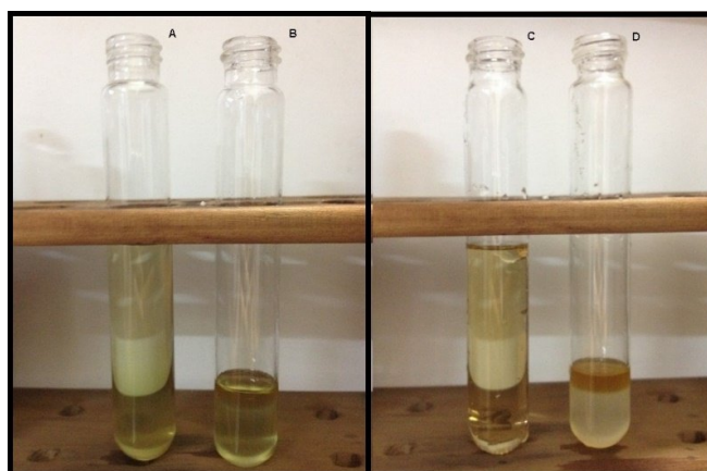
Figura 12. Reação de Liebermann-Buchard para os extratos (a) alcoólico e (c) hidroalcoólico; Reação de Salkowski para os extratos (b) alcoólico e (d) hidroalcoólico
