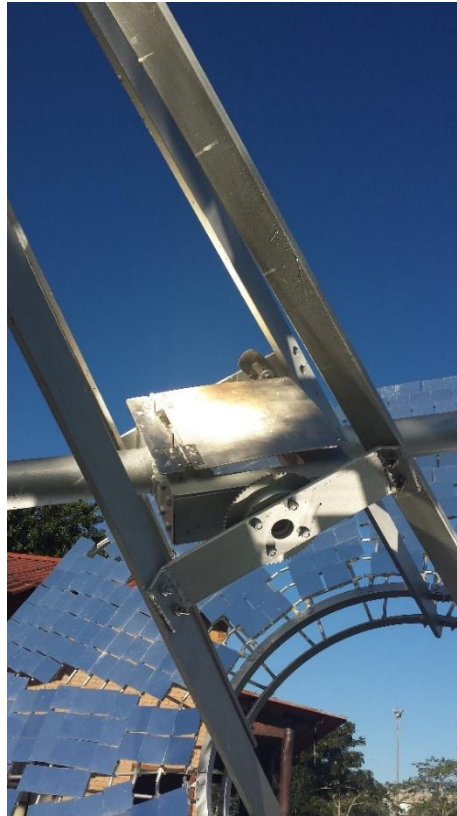
Figura 35: Foco do disco, no local onde será colocado o reator onde passará a água.
