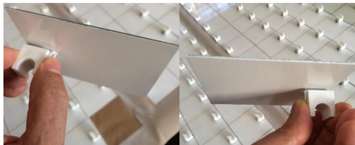
Figura 33: Proteção realizada com a camada de tinta na parte posterior dos espelhos primários.
