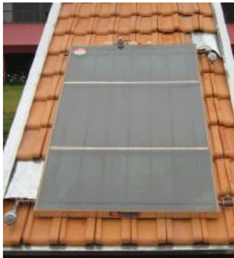
Figura 6: Vista frontal do coletor - Lados esquerdo inferior e direito superior, os sensores de temperatura (Fonte: Basso et. al, 2010).
