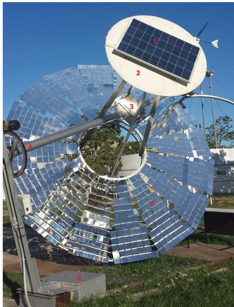
Figura 22: Disco solar montado na Casa Ecológica da UENF. 1- Placa fotovoltaica. 2 – Espelho secundário. 3 – Foco da Radiação. 4 – Roda dentada responsável pela rotação do disco (seguimento solar). 5 – Espelhos primários. 6 – Compartimento da bateria que alimenta o sistema.
