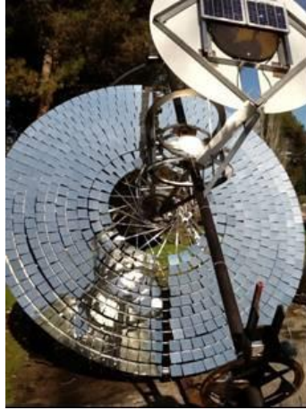
Figura 21: Disco solar de dupla reflexão e foco fixo.
