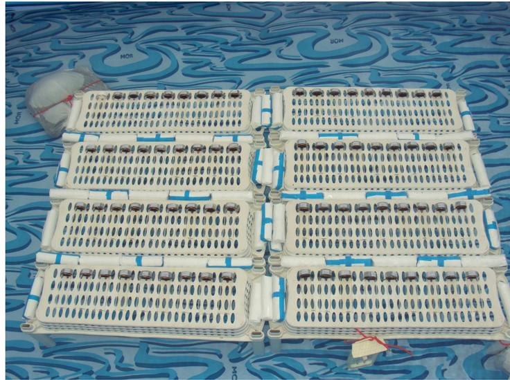
Figura 13 – Distribuição dos tubos de borossilicato na piscina para o teste de degradação.
