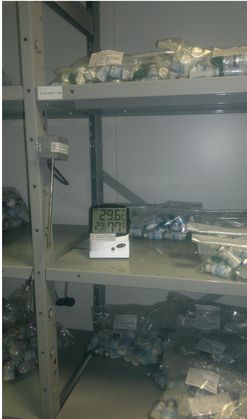
Figura 2c – Disposição do termohigrômetro e dos sensores de temperatura e umidade relativa na câmara de estabilidade.
