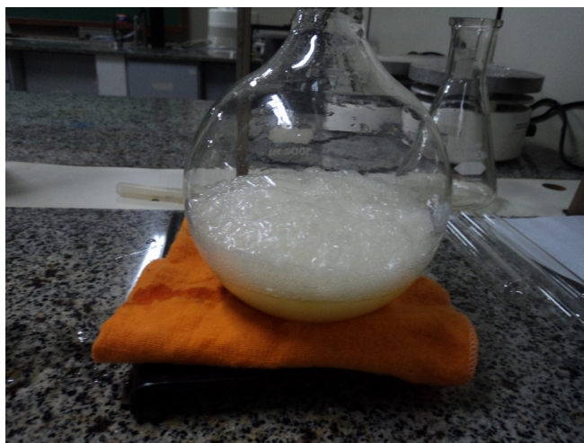
Figura 20: evolução de gases \text{CO}_2 na identificação de carbonato na amostra 3.
