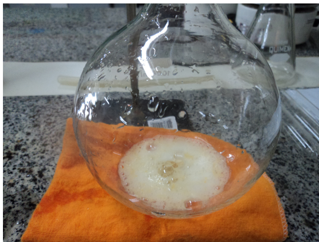
Figura 21: evolução de gases \text{CO}_2 na identificação de carbonato na amostra 2.
