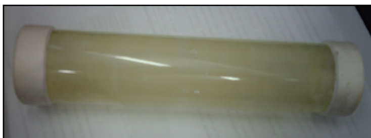
Figura 5: Tubo de vidro impregnado com \text{TiO}_2 /HPA
