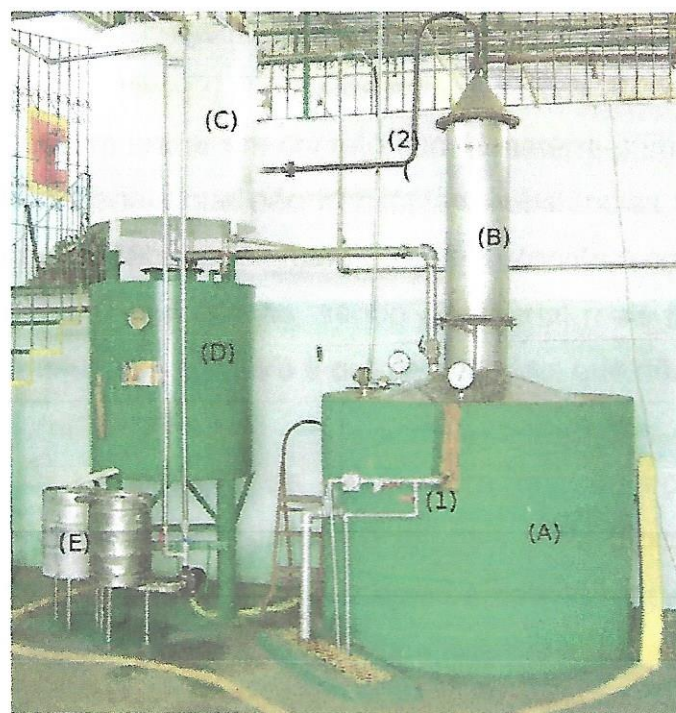
Figura 1: Exemplo de destilador: (A) panela, (B) coluna, (C) pré aquecimento do vinho para próxima destilação, (D) condensador, (E) sistema de corte do destilado.
