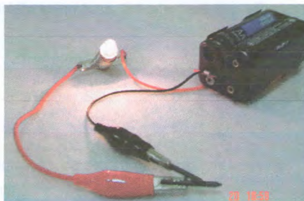
Figura 7: Sistema em circuito fechado.
