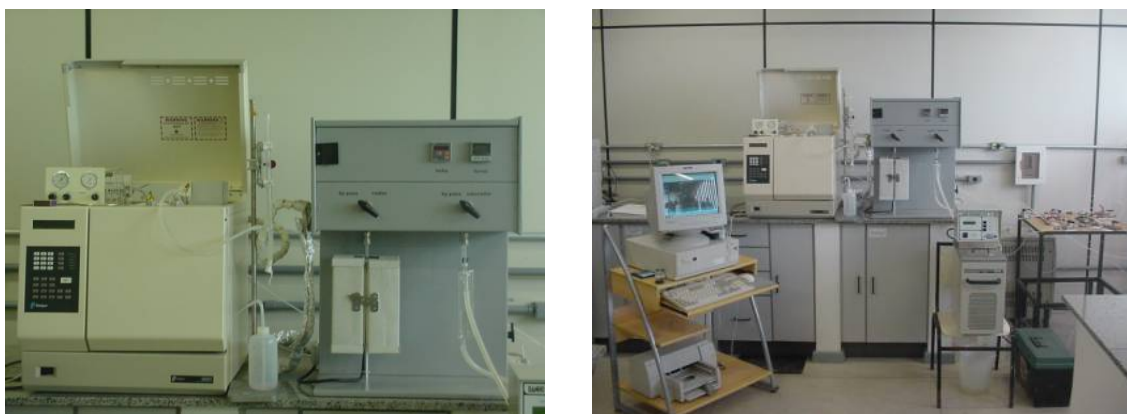
Figura 9: Foto ilustrativa do teste catalítico acoplado ao cromatógrafo.
