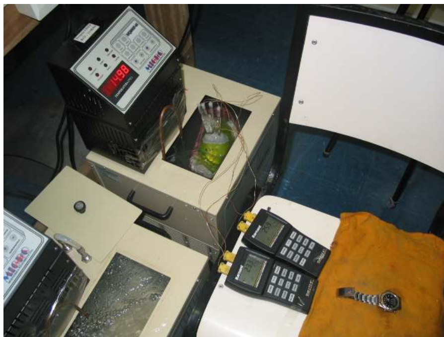
Figura 3.8 – Foto da montagem experimental. O fruto de mamão sendo submerso em banho térmico com temperatura e tempo de exposição controlados.
