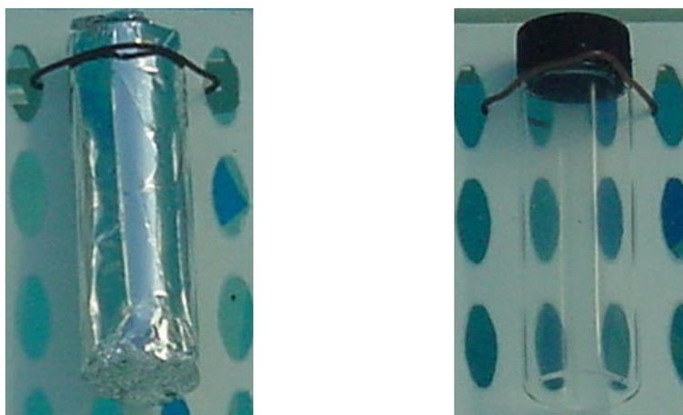
**Figura 6:** Frascos de borossilicato, com e sem papel alumínio, expostos ao sol, imersos em água
