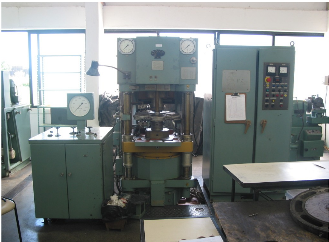
Figura 5.1 – Prensa industrial de sinterização 630 toneladas
