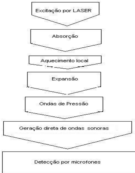
Figura 3.1: Diagrama dos processos físicos que ocorrem no gás começando pela excitação e terminando na detecção do som por microfones. [76].
