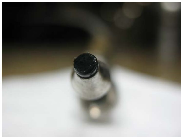
Figura 42 – Tubo de coleta das amostras gasosas entupido pelo particulado da exaustão de ônibus urbano.
