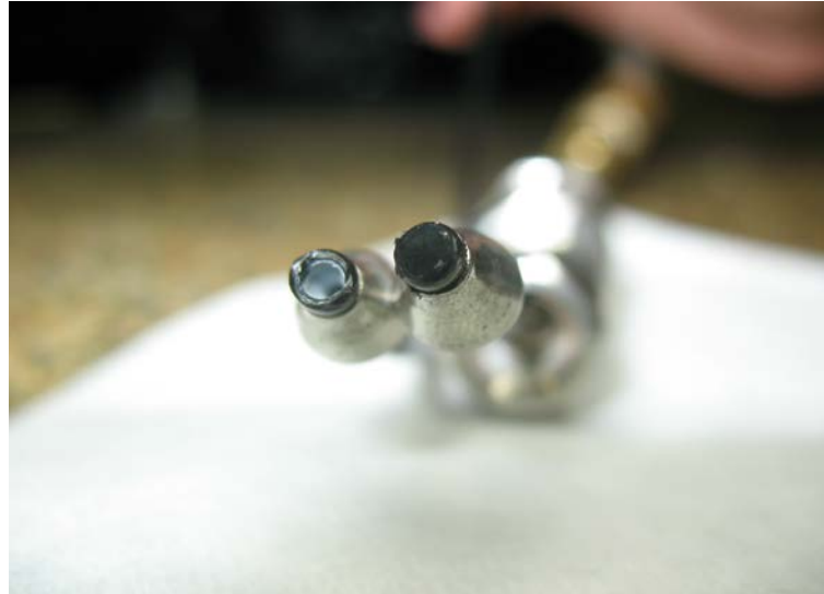
Figura 43 – Comparação entre o tubo entupido e um tubo novo.
