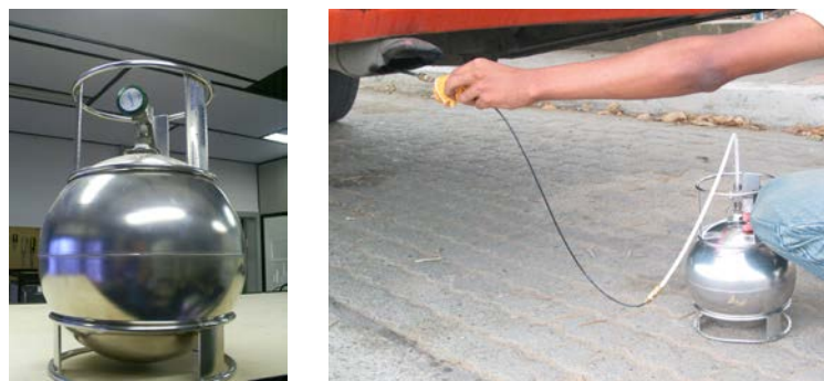
Figura 20 – Fotos do Canister e Procedimento de Coleta.
