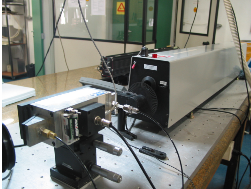
Figura 8 – Foto do arranjo experimental (laser de CO 2 e a célula fotoacústica)
