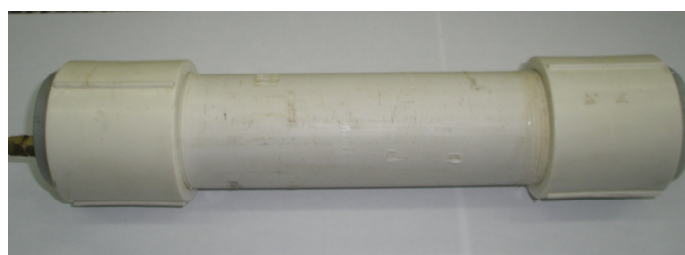
Figura 14: Reator tubular utilizado nos experimentos de fotodegradação catalítica
