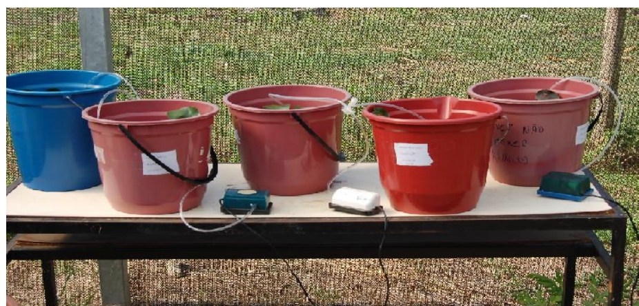
Figura 3.1 – Experimento realizado na casa de vegetação. Recipientes contendo as macrófitas, da esquerda para a direita: controle, 1mM de \text{Cr}^{+3} , 10mM de \text{Cr}^{+3} , 1mM de \text{Cr}^{+6} e 10mM de \text{Cr}^{+6} .
