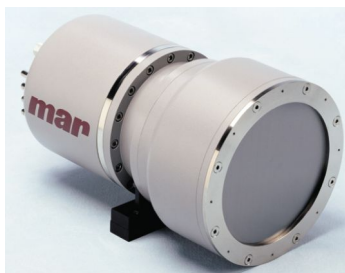
Figura 13 – Detector bidimensional com 165 mm de diâmetro, resolução de 2048×2048 pixels, cada pixel com área de 79×79µm.
