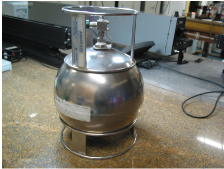
Figura 17. (a) Foto do canister (b) Foto da bomba coletora AVOCs
