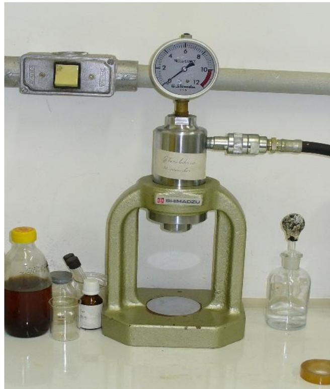
Figura 4.1 – Prensa utilizada para a preparação dos discos cerâmicos para as medidas de difusividade térmica e capacidade térmica específica.
