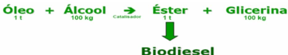
**Figura 2.3: Esquema do processo de produção do biodiesel**
