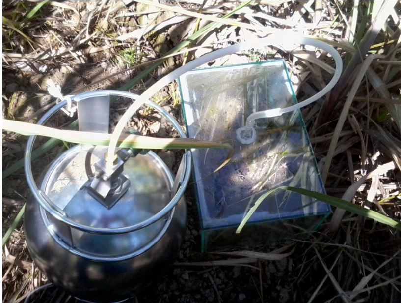
Figura 22: Canister Portátil utilizado para captura das amostras gasosas, provenientes das emissões dos solos, contidas no interior das cúpulas estáticas.
