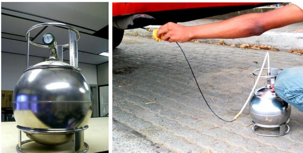
**Figura 13** - (a)Canister e (b) procedimento de coleta
