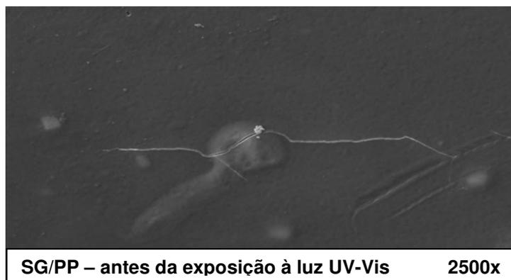
**Figura 27.** Micrografias do PP com  $\text{TiO}_2$  sol-gel.
