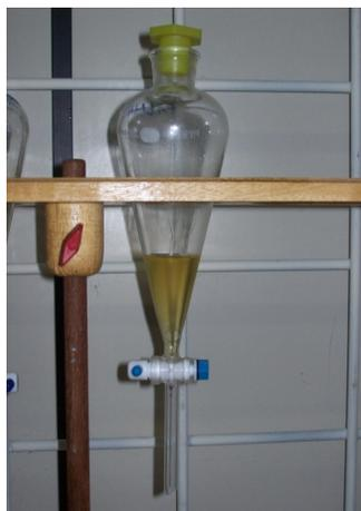
FIGURA 19- ILUSTRAÇÃO DO FUNIL DE SEPARAÇÃO DO BIODIESEL DA GLICERINA.
