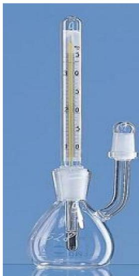
FIGURA 16- ILUSTRAÇÃO DE PICNÔMETRO.
