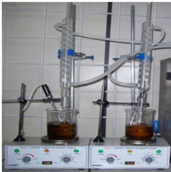
FIGURA 18- SISTEMA EXPERIMENTAL PARA REALIZAR AS REAÇÕES DE BIODIESEL.
