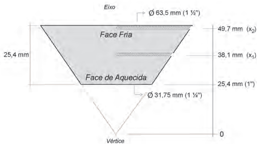
Figura 3.5: Vista em corte da peça cônica, com os furos para inserção dos termopares posicionados ao longo do eixo da peça.
