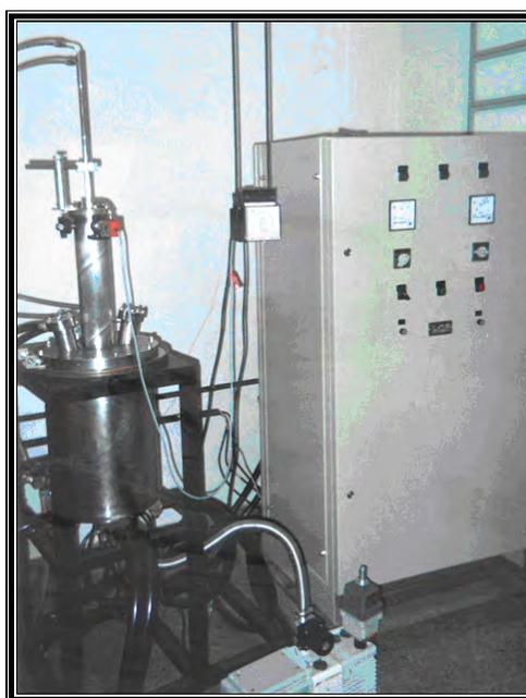
Figura 4.5: Foto do forno a vácuo utilizado para preparação das amostras.
