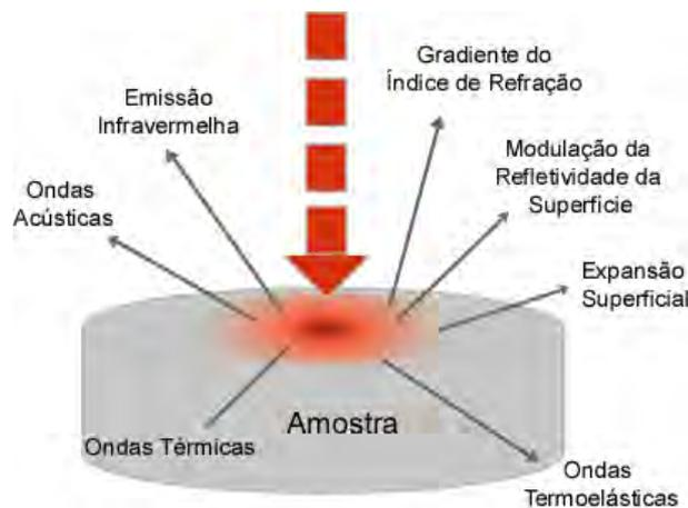
Figura 2.1: Fenômenos que podem ocorrer pela interação de uma radiação modulada com uma amostra.
