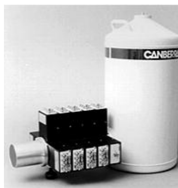
Figura C.7: Detector de germânio normalmente utilizado nas medidas de fluorescência. Ele deve ser mantido resfriado com nitrogênio líquido (reservatório criogênico ao lado do detector).
