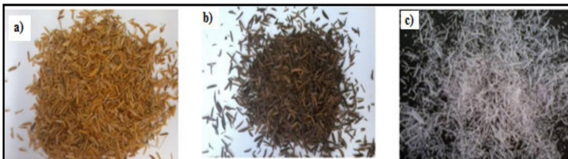
Figura 9 - Processo de preparação das CCA: a) casca de arroz lavada em água destilada e seca a 100°C; b) casca de arroz lixiviada e seca a 100°C; c) cinzas de casca de arroz calcinada a 700°C.
