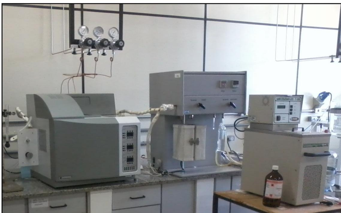
Figura 16 - Foto ilustrativa do sistema de reação teste de desidrogenação do ciclohexano.
