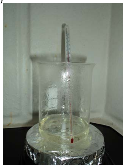
Figura 4.4: Etapas da preparação do fósforo CABYME2,5 pelo método sol-gel tipo Pechini: A) Início da reação de esterificação, B) Estágio intermediário da formação do gel.
