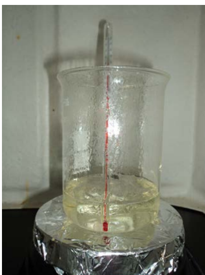
Figura 4.4: Etapas da preparação do fósforo CABYME2,5 pelo método sol-gel tipo Pechini: A) Início da reação de esterificação, B) Estágio intermediário da formação do gel.
