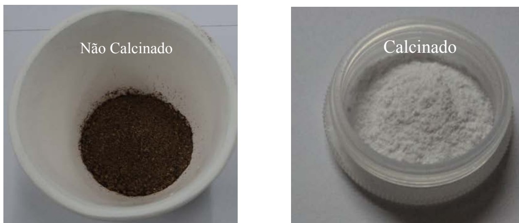
Figura 4.6: Fósforo não calcinado e calcinado à 750 °C durante 12h.
