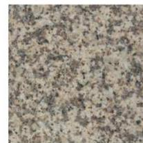
No granito identificamos os componentes: quartzo, feldspato e mica.
