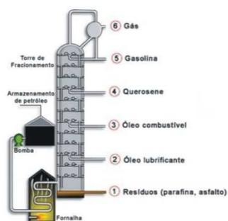
Obtenção de derivados do petróleo por destilação fracionada.
