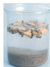
Raspas de madeira podem ser separadas da areia pela diferença de densidade na água.
