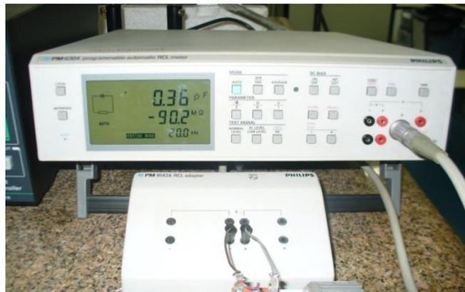
**FIGURA 19:** Medidor RCL usado nas medidas de capacitância.
