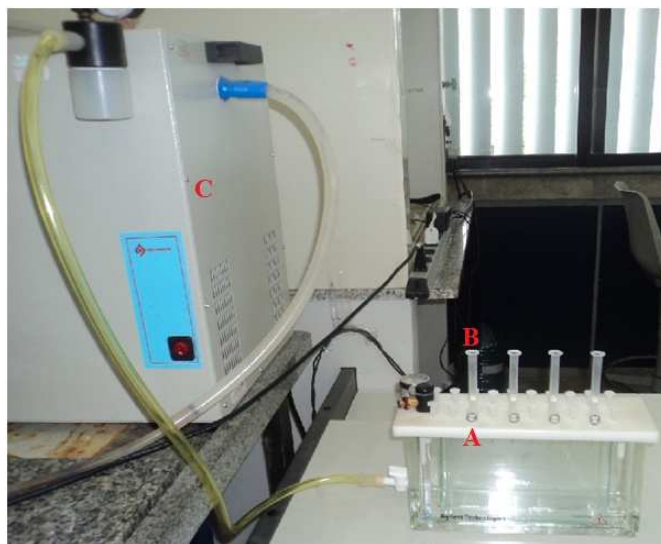
Figura 17: Aparato necessário para a realização da extração em fase sólida (A = manifold de extração; B = cartucho de extração; C = bomba à vácuo).
