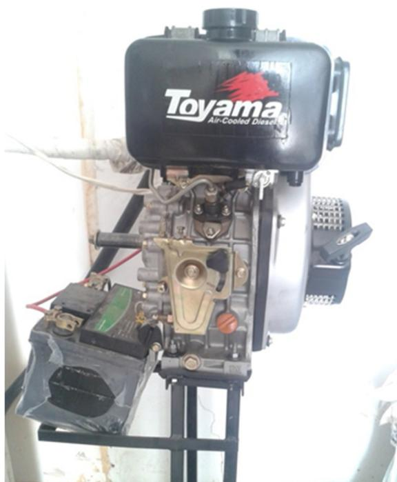
Figura 11: Foto do motor de bancada monocilíndrico Toyama - TD70FE
