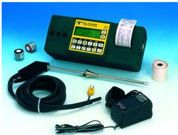
Figura 6: Analisador eletroquímico TEMPEST100®[109]
