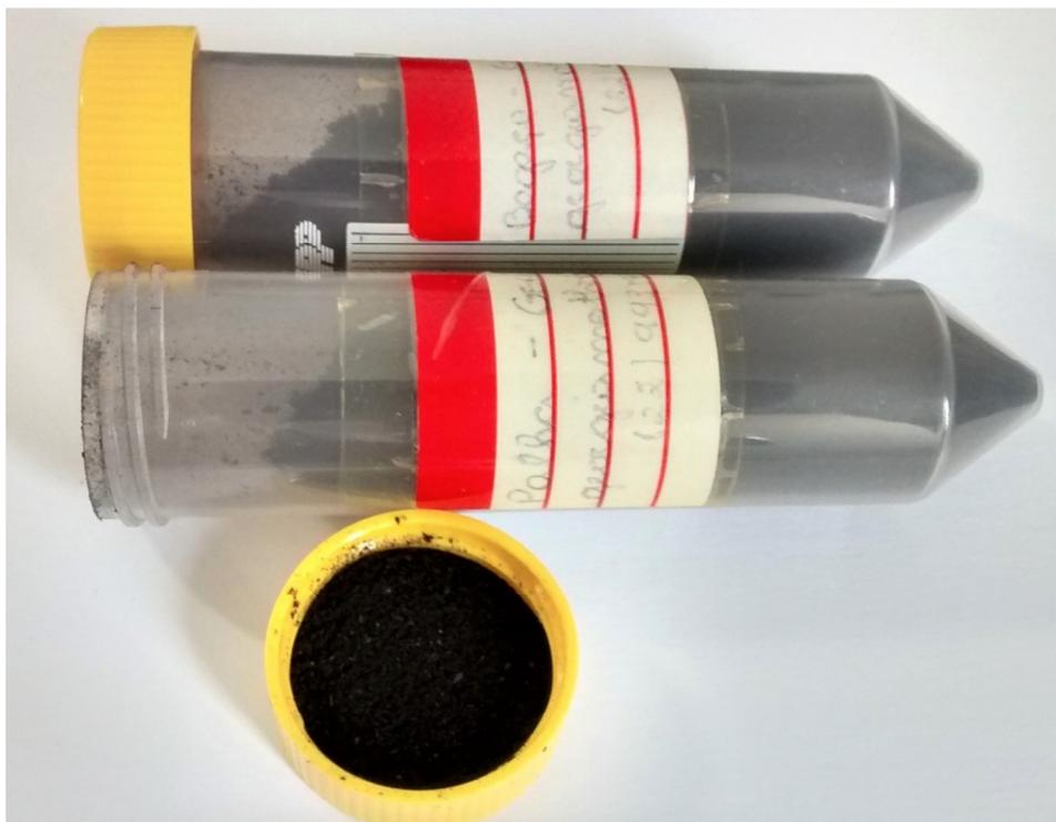
Figura 13: Fuligem obtida através da queima da palha e do bagaço da cana-de-açúcar.
