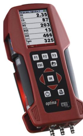
Figura 7: Analisador eletroquímico Optima7[110]
