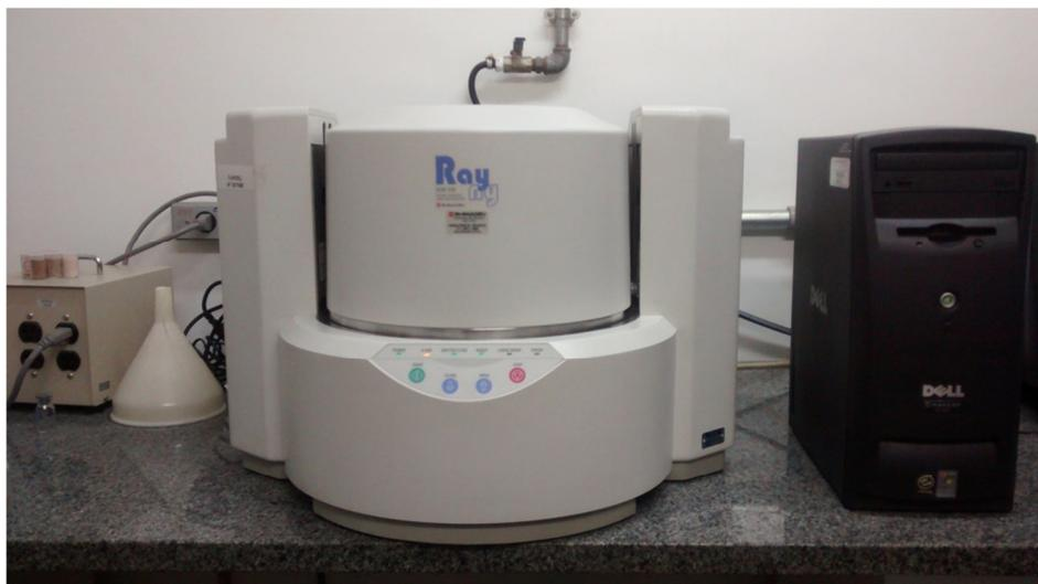
Figura 8: Foto do espectrômetro EDS-XRF, baseado em fluorescência de raiosX
