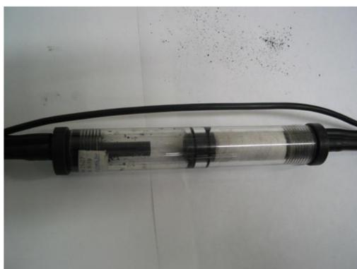
Figura 10: Detalhe dos filtros de condensação do vapor d'água e de retenção de material particulado da mangueira coletora do Analisador Eletroquímico (TEMPEST100).
