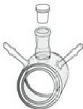
Figura 7.1. Cubeta de quartzo com fluxo em torno do compartimento da amostra.
